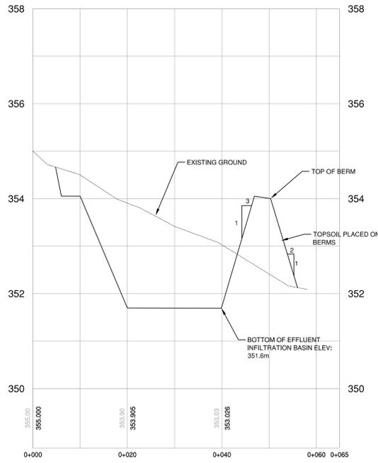
**B EFFLUENT INFILTRATION BASIN SECTION B-B**
